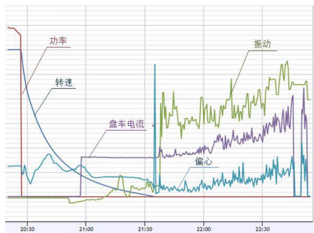
图2 轴封温度不匹配导致机组抱轴过程
