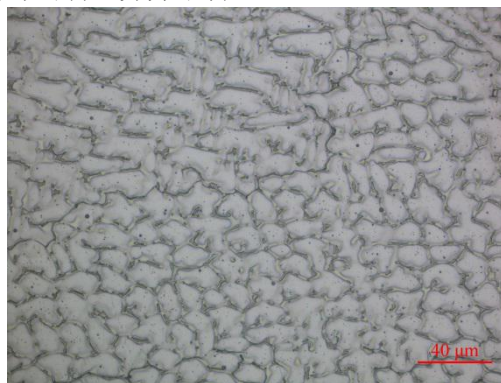
图6 经过时效冲击处理后的焊缝组织
