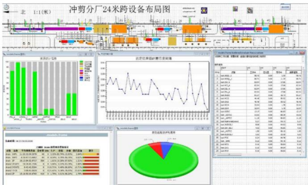
图1 定子冲片车间布局调整物流分析图
