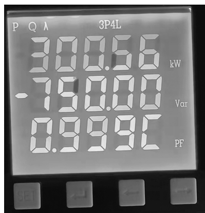
图 8 氢燃料电池保供车电源系统 300 kW 输出试验结果
