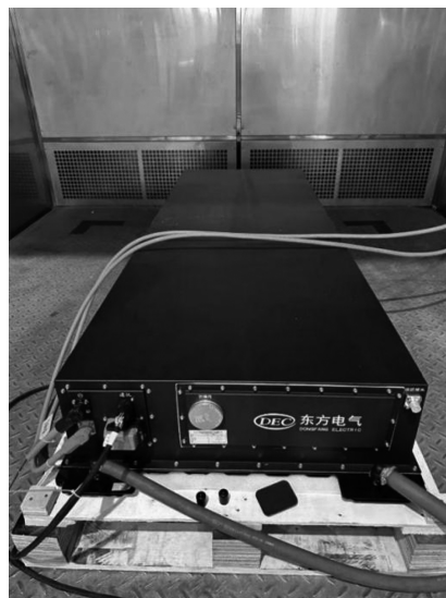
图11 104串液冷电池包现场测试图
